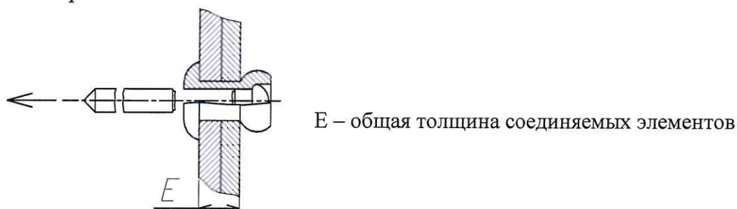
Рис. 2. Общий вид заклепочного соединения
